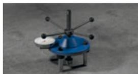
L'analisi dell'adesività alla resistenza alla trazione del sottofondo deve essere esaminata con uno strumento di misura adatto.
