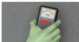
Non in tutti i punti è possibile determinare l'umidità residua con un metodo di misurazione elettronico. Tuttavia, consigliamo di impiegare tale metodo non distruttivo per ottenere dei valori indicativi.
