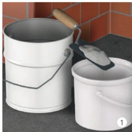
Riempire un secchio con la quantità necessaria di sabbia di quarzo (0,1–0,6 mm), aggiungere BIKUCOAT-SMP ECO (rapp. miscela 1:5), mescolare con attrezzi meccanici o cazzuola.
