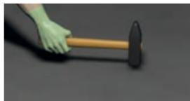
Esaminare il sottofondo con un martello per individuare i punti cavi. Segnare i punti.
