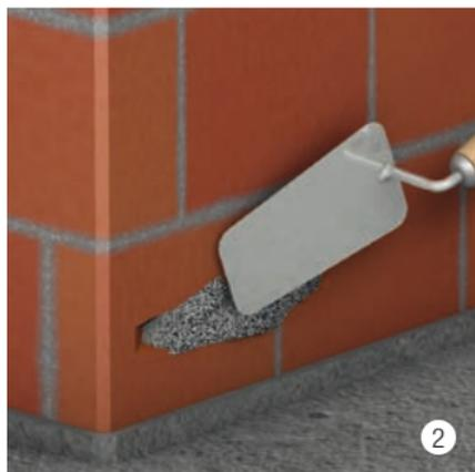
Preparare il sottofondo secondo la tabella dei sottofondi. In caso di necessità, applicare uno strato di BIKUCOAT-Universalprimer 2K. Prima stendere uno strato fine di BIKUCOAT-SMP ECO, poi applicare il mastice. Alternativa: BIKUCOAT-SMP ECO e Weplus 910 Addensante
